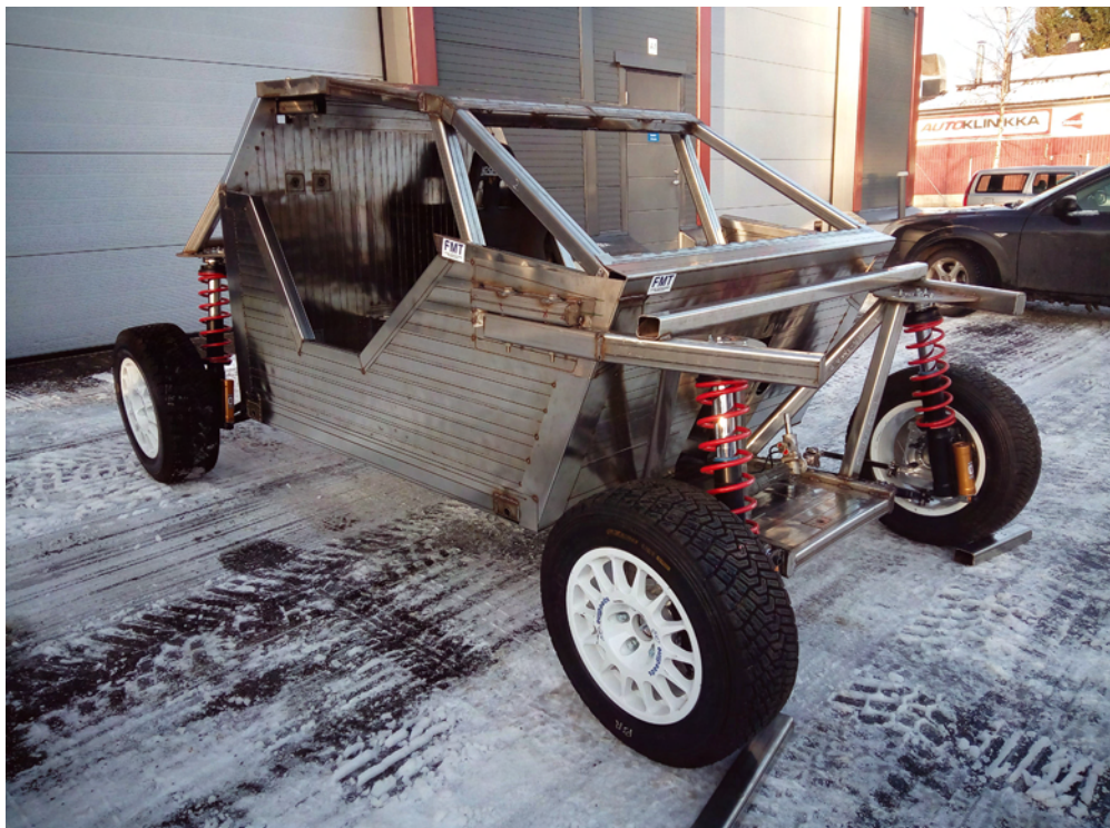
Ultralujasta teräksestä valmistettu ralliauton runko.
