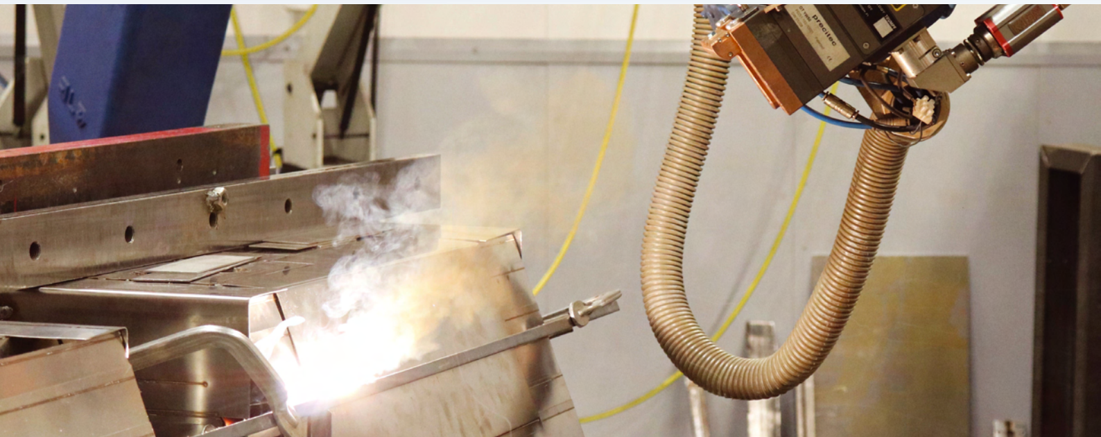
Muokkauslujitetun ruostumattoman teräksen laserhitsaus.
